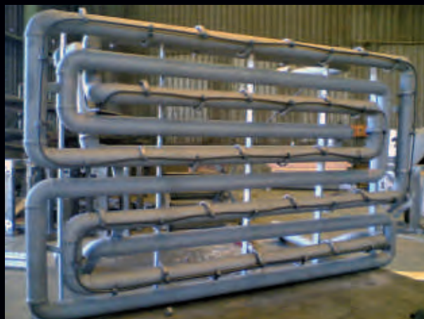
損耗した水冷パネル断面(OPTISAVEセンサーが組み込まれている)
