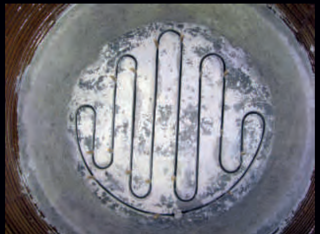
誘導炉炉床 / プッシュアウトブロック
