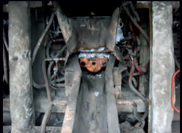
タップホールブロックを組み込んだところ
