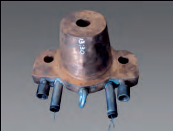
OPTISAVEセンサーを組み込んだスラグタップ ホールの銅製水冷ユニット
