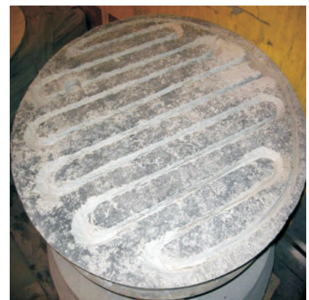
▲ Plaque d'éjection préparée pour l'installation des capteurs SAVELINE
