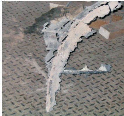
▲ Langue de métal du remplissage arrière d'un garnissage en pierres
