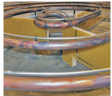
▲ Disposition des capteurs dans le four à arc sous le registre de refroidissement (à gauche) et disposition prédéfinie du fil du capteur (à droite)
